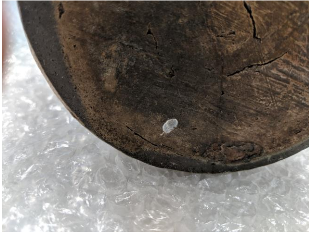
Stelle der Probenziehung am Boden einer Keramik, Durchmesser ca. 5 mm
