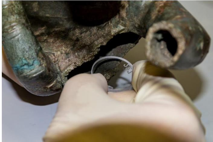
Probennahme durch Abrieb an einem bronzenen Handfragment für TXRF Analyse.
