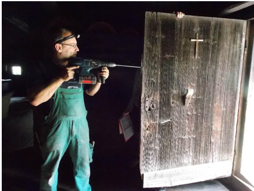
Beprobung einer Holztüre im Österreichischen Freilichtmuseum Stübing
