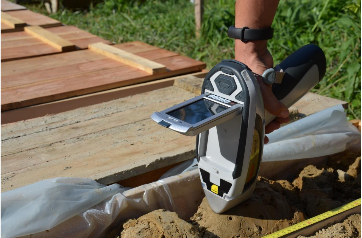
Tragbares RFA-Messgerät zur zerstörungsfreien Bestimmung chemischer Zusammensetzungen von Gesteinen und Böden. Diese Methodik kam auch bei der Untersuchung von römischen Naturwerksteinen zum Einsatz (CarVin Projekt).
