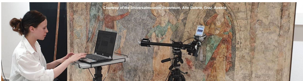
Fig. 1: Training on Handheld XRF analysis of mural paintings (in cooperation with Akademie der bildenden Künste Wien, Institut für Konservierung und Restaurierung, Fachbereich Wandmalerei und Architekturoberfläche, photography reproduced by courtesy of Old Gallery of the Universalmuseum Joanneum, Graz, Austria)
